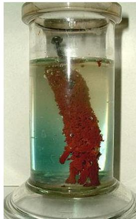
Abbildung 21 Eisenstab in Kupfersulfatlösung<sup>14</sup>
